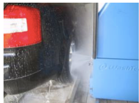
Lisävarusteena on saatavilla yhdistelmäpyöräpesuri, jossa korkeapainepyöräpesuriin on yhdistetty 21" pyöräharja.
