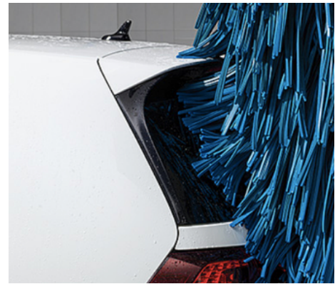
MultiFlex järjestelmän avulla kallistuvat sivuharjat myös pituussuunnassa taaten hyvän peräpesutuloksen myös farmari ja SUV-autojen perän pesuun.
