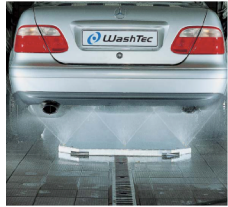
Alustanpesuri tunnistaa auton pituuden ja sen segmenttirakenne varmistaa, että alustanpesurilla pestään vain auton pohjaa, ei pesuhallin kattoa.
